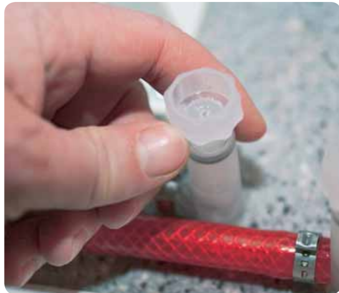
Ablauf: Spezielle Ventile entleeren den Tank und den Boiler komplett. Bei längeren Reisepausen sollte das Mobil immer mit leeren Tanks stehen.
