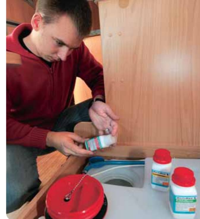
Mixturen: Keime und Bakterien sind mit speziellen Lösungen zu entfernen. Diese kommen nach Anleitung dosiert direkt in den Frischwassertank.
