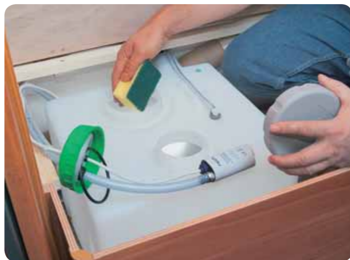
Innenleben: Kräftiges Schrubben entfernt groben Schmutz im Tank. Ein Spülschwamm und spezielle Bürsten eignen sich dafür besonders gut.
